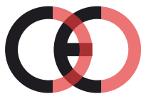
Faux marquage CE (trop proche)
