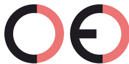
Faux marquage CE (trop éloignée)
